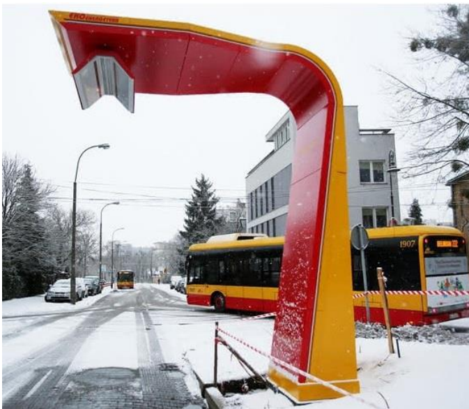
Fot. Przykład pantografu zintegrowanego z ładowarką.
