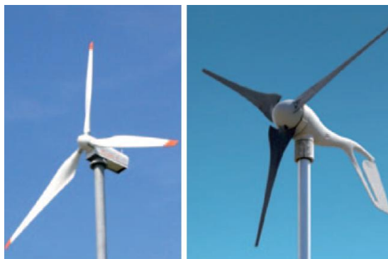
Rysunek 21 Turbiny o poziomej osi obrotu 198
